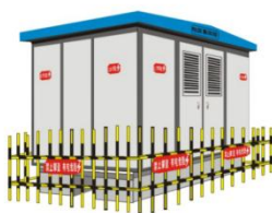
图3 电源配电箱标准结构及外观示意图
